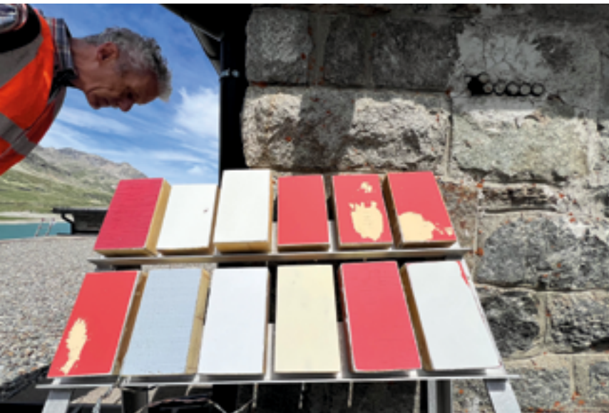
Letzte Inspektion der Bewitterungsversuch-Sandwich-Teile vor dem Abbau.
