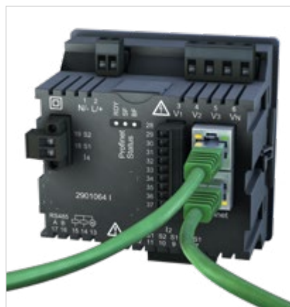
Abb.: UMG 96RM-PN mit Profinet-Schnittstelle
