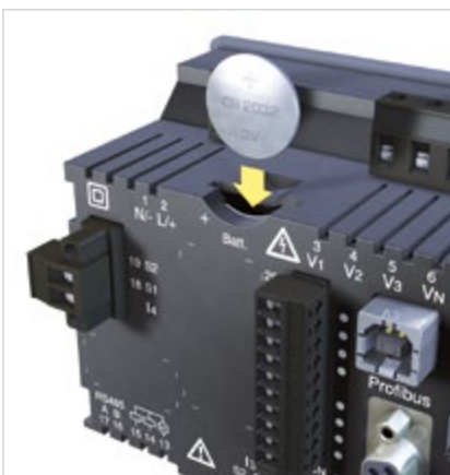
Abb.: Batterieeinsatz auf der Rückseite (UMG 96RM-P)
