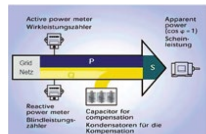
Abb.: Prinzip der Blindleistungskompensation
