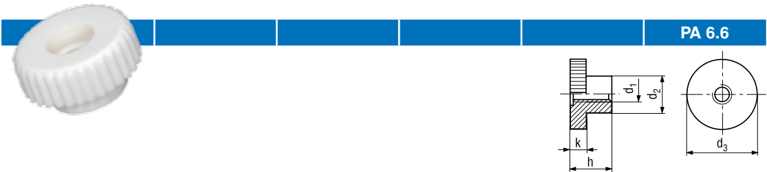
Høje rouletmøtrikker Knurled nuts high type Hohe Rändelmuttern Polyamid PA 6.6 Bestillingseksempel: BN 5933 - M4 Polyamide PA 6.6 Ordering example: BN 5933 - M4 Polyamid PA 6.6 Bestellbeispiel: BN 5933 - M4
